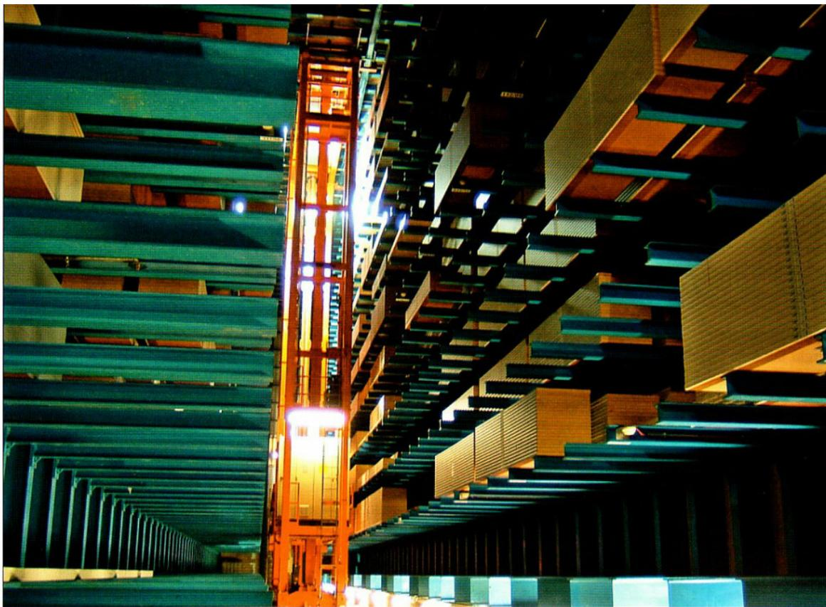
Automatisches Lager- und Kommissioniersystem für plattenförmige Güter mit zwei unabhängig arbeitenden Hubplattformen (Abb.: Systraplan)
