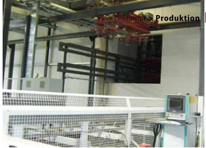
Beschickung mit Vakuumtransporteur
